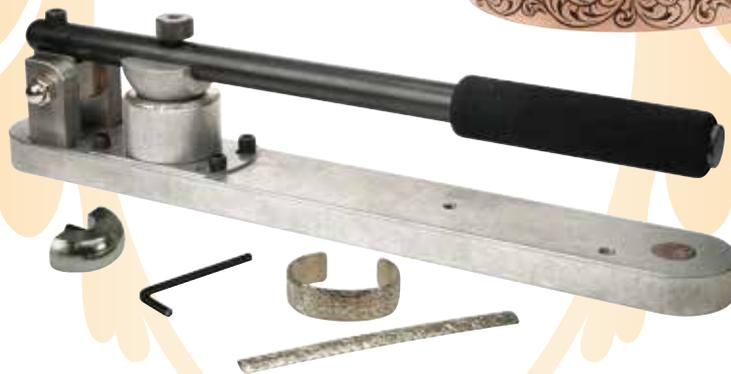
Forme pulseiras em «C» facilmente com o Formador de Pulseiras GRS. Forme faixas planas de metal em «C» perfeito após gravar o desenho. A taça de molde contém um material de liga mole que suporta a pressão do molde, mas não distorce o trabalho gravado. O material da taça de molde pode ser reformado através de aquecimento, se necessário.
