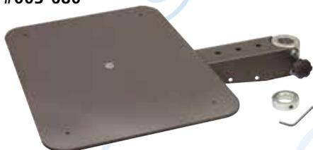
Esta prateleira (40,5 x 29 cm) é uma excelente forma de obter espaço extra para as ferramentas. Fabricada em alumínio sólido de 6,3 mm com um acabamento robusto, texturizado e com revestimento de pó, esta prateleira pode ser bloqueada em qualquer posição e roda livremente. De elevada qualidade de construção, para montagem num suporte de microscópio GRS ou poste com diâmetro de 28,5 mm.
