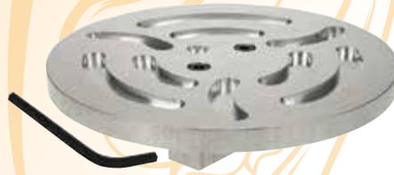
Originalmente concebido para assistir os artistas de scrimshaw no Training Center da GRS na fixação de painéis em marfim para gravação, esta ferramenta única utiliza argila de modelagem ou Thermo-Loc, que pode ser pressionado para dentro das ranhuras fresadas para fixar suavemente uma peça de trabalho sem provocar danos. Ideal para trabalho de detalhe de peças finas e leves que não podem ser agarradas num torno de esfera.
