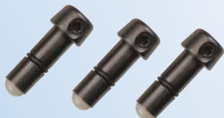
Altere as características de impacto das peças de mão GRS simplesmente, montando uma ferramenta ou gravador nestes novos Porta-Ferramentas QC de Impacto Ligeiro. Proporcionam um impacto mais reduzido pois a parte traseira do porta-ferramentas é fabricada com uma ponta plástica especial. Isto permite uma transferência de energia mais suave do pistão da peça de mão para
