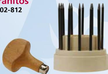
Ferramentas em aço côncavo endurecido para formação de contas em torno de pedras ou fundos pontilhados. O conjunto inclui doze ferramentas de contas: Tamanho 2, 4 e 6 – 16. A ferramenta #16 produz uma conta ou ponto de 1 mm. O tamanho da ferramenta aumenta 0,05 mm.
