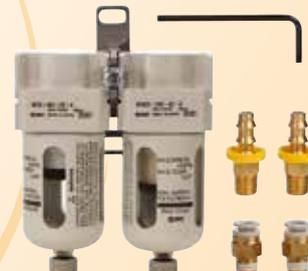
Este kit de filtro do ar/remoção de óleo compacto une os dois filtros, assim como o suporte de montagem numa única peça. Elimina, de forma fiável, a sujidade e o óleo do ar comprimido, sendo necessário se utilizar os nossos equipamentos GRS com um compressor de tipo óleo. As ligações foram concebidas para tubos flexíveis de 6 mm. Para a fixação a paredes ou bancadas de trabalho, recomenda-se a utilização de parafusos M5 (não incluídos).
